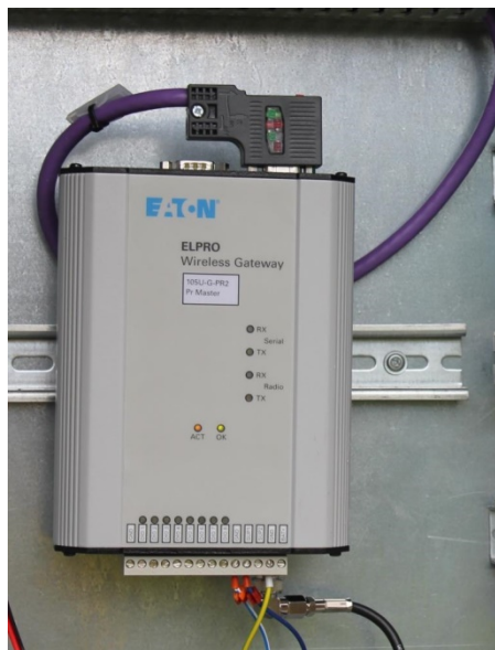
Radiomodemet Elpro 105U Wireless PROFIBUS Gateway fra Eaton. Udstyret forhandles i Danmark af GreenMatic i Kastrup. Øverst er PROFIBUS-tilslutningen og nederst ses de eksterne spændings- og antenntilslutninger.
